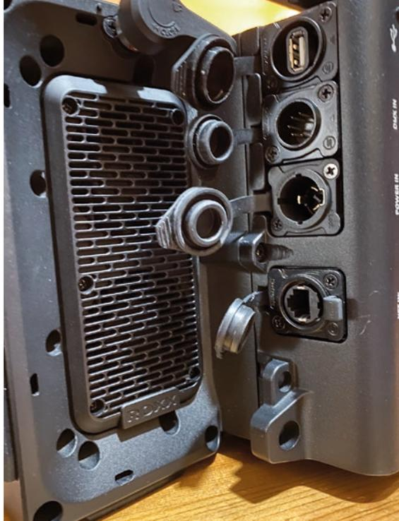
**Anschlüsse wasserdicht eingepackt** Neu dazu-gekommen ist eine RJ45-Netzwerkschnittstelle
