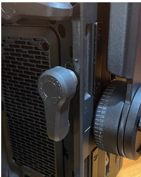
Ein patentiertes C-Lok verankert die Geräte miteinander, während sie von starken Pre-Link-Magneten exakt positioniert werden
